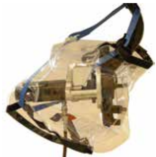
Beispiel eines Hydraulikwerkzeugs mit Schutzvorrichtung und Sicherungsriemen.
