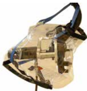
Esempio di attrezzo idraulico dotato di dispositivo di protezione e cinghia di sicurezza.
