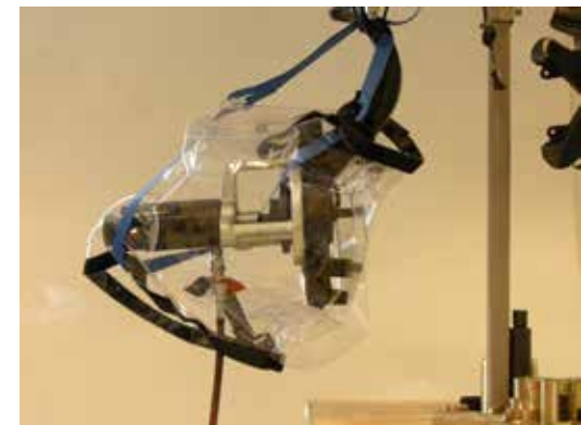
Beispiel für Hydraulikwerkzeug mit Schutz und Gurtverankerung
