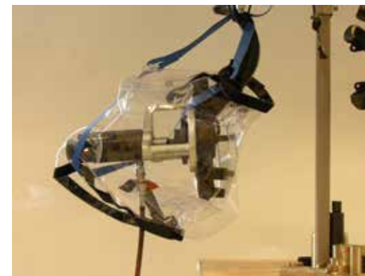
Exempel på hydraulverktyg applicerat med skydd och fångrem
