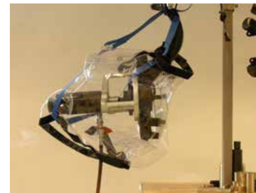
Voorbeeld van hydraulisch gereedschap met veiligheidshoes en bevestigingsband
