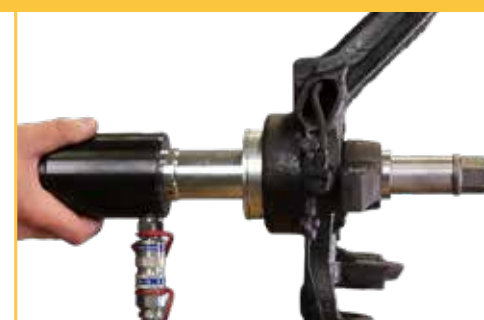
Monteren nieuw wielager
