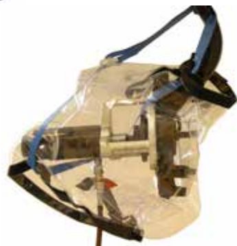
Voorbeeld van hydraulische cilinder met bescherming en vangriem 04-00015.
