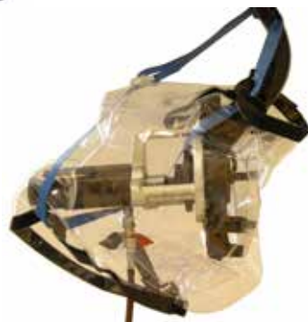
Exemple d'outil hydraulique avec protection et harnais 04-00015.
