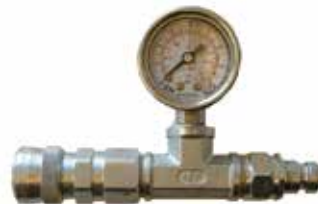
Werkdruk meten met manometerset (art.nr. 04-00016)
