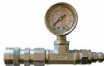
Werkdruk meten met manometerset (art.nr. 04-00016)
