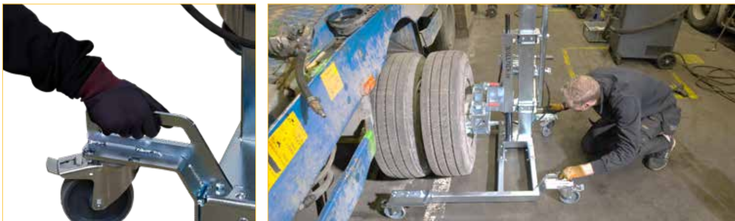
De bakre handtagen ger extra stöd vid montering av nav på hjulaxeln.
