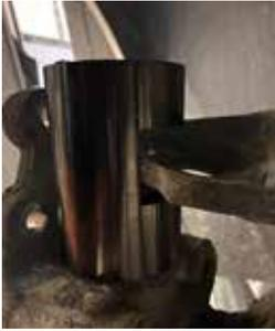
Demontagerohr mit Öffnung für die Stoßdämpferhalterung oberhalb der Achsschenkelbolzenposition.
