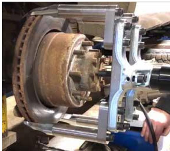
Dieses Zusatzset wird mit dem Brems-scheiben-/Rotorabzieher 01-00048 verwendet. Presst Scheiben/Rotoren bis zu Ø 390 mm (15,35 Zoll), ohne die Radlager zu zerstören, selbst wenn die Scheibe/der Rotor über 336 mm groß ist. Der Bedarf ist bei Hochleistungsmodellen von Volvo, BMW, MB, Porsche, Tesla und anderen zu sehen. Auch vorne und hinten bei US-Pickups 150 – 350 und 1500 – 3500, Dodge, Chevrolet, GMC und Ford.
