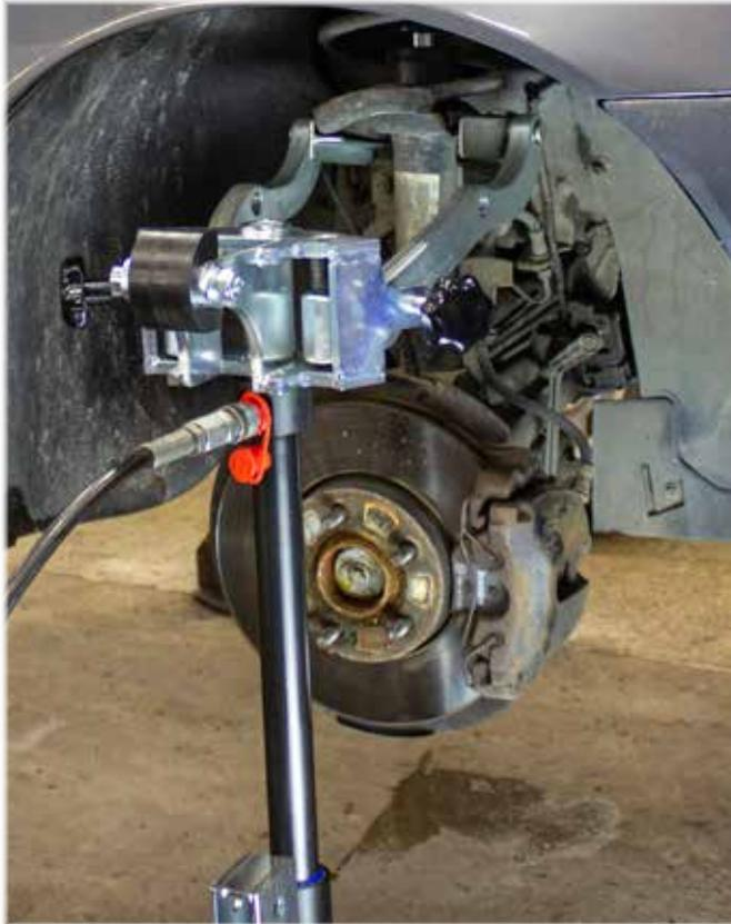
Das Federwerkzeug kann auch bei der Trennung von Achsschenkeln und Federbeinen zur Entlastung der Federbeine verwendet werden. Dies erfolgt direkt im Fahrzeug und reduziert die Arbeitszeit wesentlich.
