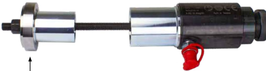
Bei Verwendung einer Zugstange dient der Deckel als Anschlag für die Mutter. Zur einfachen Handhabung ist das Druckrohr im Deckel verriegelt. Verwendbar mit Zugstangen der Größen M10, M12 und M14. Siehe Seite 58
