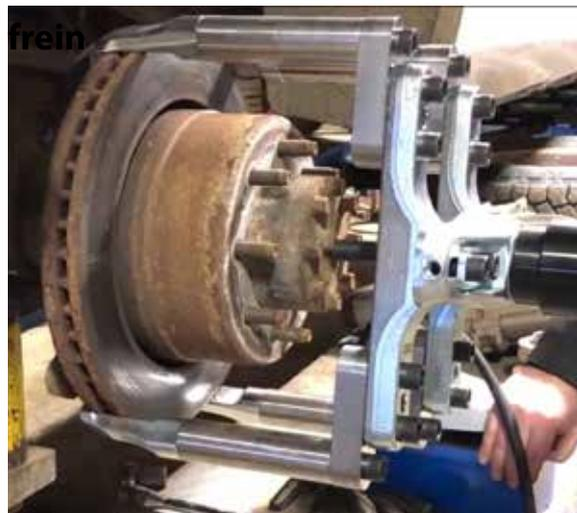
Cet ensemble complémentaire est utilisé avec 01-00048. Presse des disques/rotors jusqu'à Ø 390 mm (15,35") sans endommager les roulements, même lorsque le disque/rotor fait plus de 330 mm. Cet ensemble est nécessaire pour des modèles hautes performances de Volvo, BMW, MB, Porsche, Tesla et autres.
