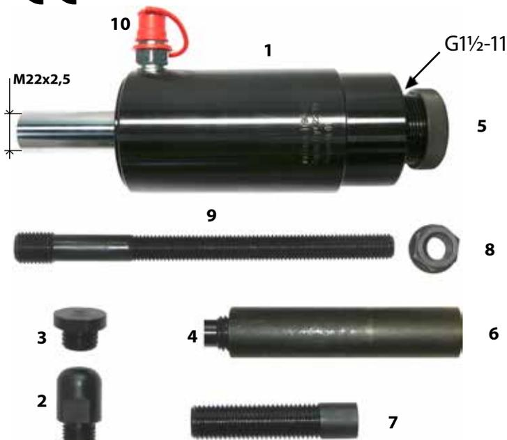
La pression hydraulique du vérin peut être associée à une force de poinçonnage avec capuchon d'impact 1086-6, par exemple pour presser un arbre de roue rouillé. Poids : 4,7 kg. Course : 70 mm. **Retour automatique.**
