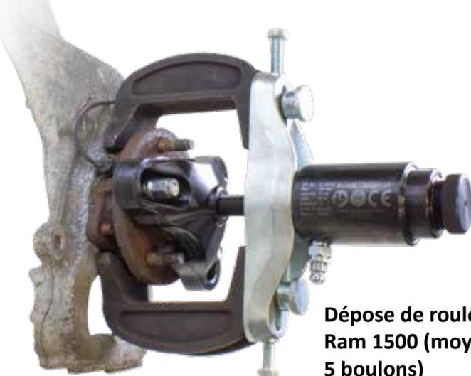
Dépose de roulement
